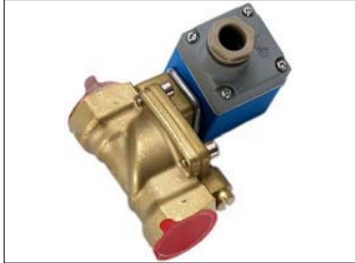
2/2 ventiil Danfoss tüüp EV 220 B DN 15 – 50 NC minimaalne rõhkude vahe 0,1 baari
