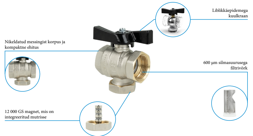
Joonis 2. BFV-kuulkraani ehitus
