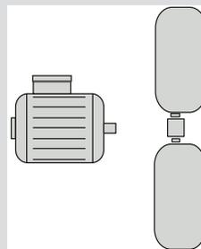
Bauform 4 (BF4): Einzelkomponenten Innenläufermotor und Lüfterflügel
