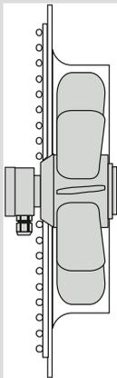
Bauform 1 (BF1): komplett vormontierte Einheit aus Außenläufermotor, Lüfterflügel, Schutzgitter, und Rückwand mit Einströmdüse
