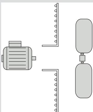
Bauform 3 (BF3): Einzelkomponenten Innenläufermotor, Lüfterflügel und Schutzgitter
