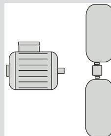
Bauform 4 (BF4): Einzelkomponenten Innenläufermotor und Lüfterflügel
