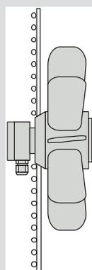
Bauform 2 (BF2): komplett vormontierte Einheit aus Außenläufermotor, Lüfterflügel und Schutzgitter
