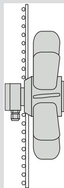
Bauform 2 (BF2): komplett vormontierte Einheit aus Außenläufermotor, Lüfterflügel und Schutzgitter
