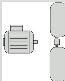
Bauform 4 (BF4): Einzelkomponenten Innenläufermotor und Lüfterflügel
