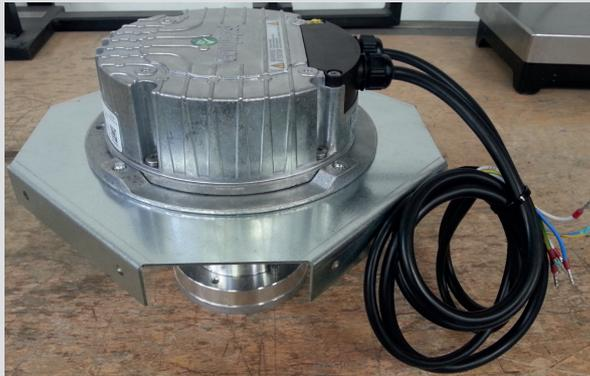
Motor mit Motorrahmen und Kabel
