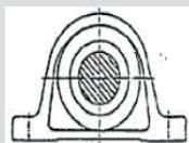
Typ2: Rillenkugellager mit Gehäuse
